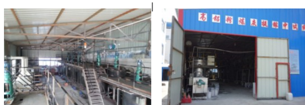
Kinesisk ekstraksjonsanlegg for gallium. I dette tilfellet har de ekstrahert alumina fra kullaske, og ekstraherer galliumet deretter fra aluminaen. Tilsynelatende tradisjonell SX-L/L-teknologi. 121
