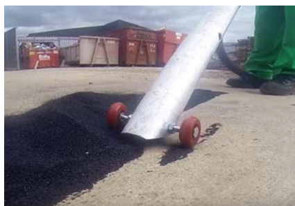
← Til høyre er et amerikansk gjenvinningsanlegg. 133 ↑ I midten: enkel og praktisk suging av brukt blåsesand. 134 → Til høyre: Hauger med forurenset blåsesand på Fosen. 135
