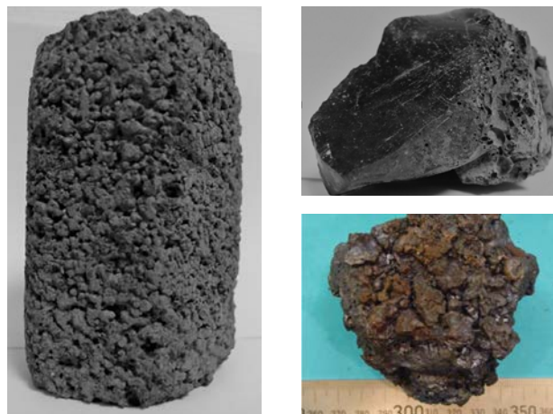
◀ Til venstre: Brikett av manganstøv agglomerert med sement for returføring til ovn. ➔ Øverst høyre: Slagg fra produksjon av silikomangan. 116 ➔ Nederst høyre: Slagg fra gjenvinning av mangan fra våtvaskerslam (Ruihua, 2007).
